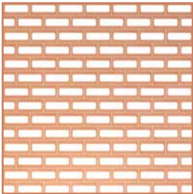
Posa orizzontale sfalsata Staggered horizontal installation
